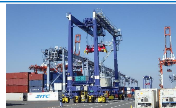
遠隔操作RTG
