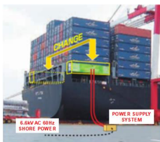
停泊中船舶への陸上電力供給
