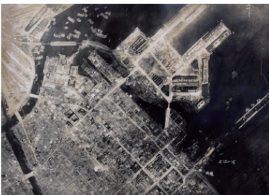
上空から見た横浜港の被災状況 1923(大正12)年『関東震災地写真帖』より 横浜船渠(左上)から、新港ふ頭、大さん橋と市 街地を撮影した航空写真。新港ふ頭では倉庫が 焼け落ち、甲号倉庫(現在の赤レンガ1号倉庫) の半分が崩壊している。大さん橋は根元から中 ほどにかけての部分完全に崩壊している
