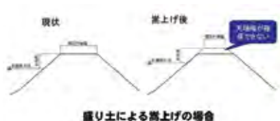
盛土による嵩上げの場合 (図-2) 盛り土の場合
