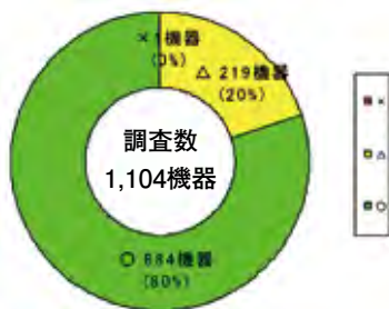
図2 排水機場の健全度調査結果
