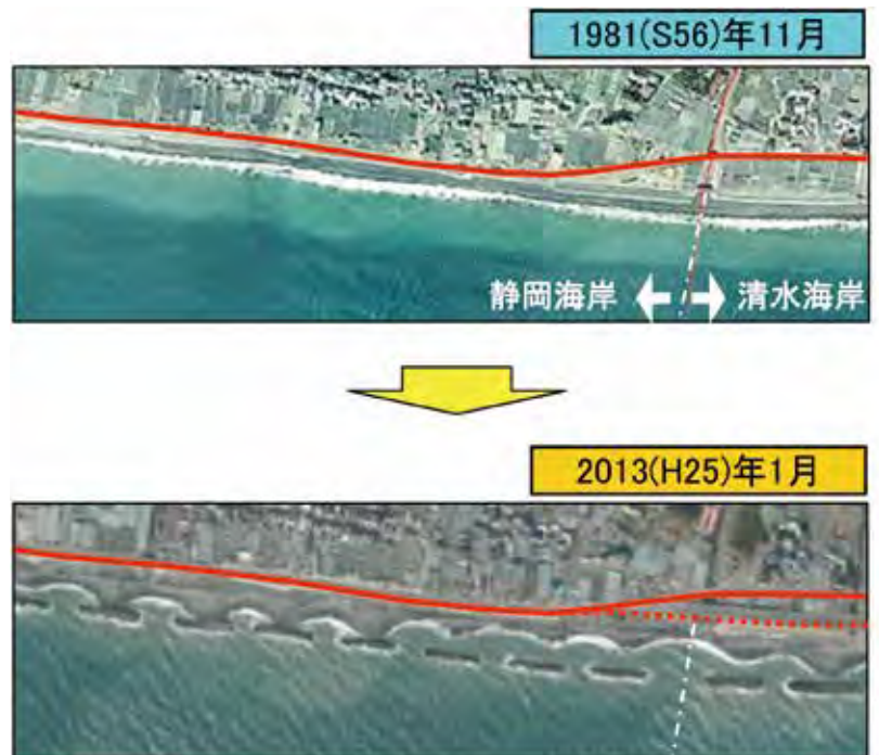
図3 消波堤・離岸堤の設置効果
