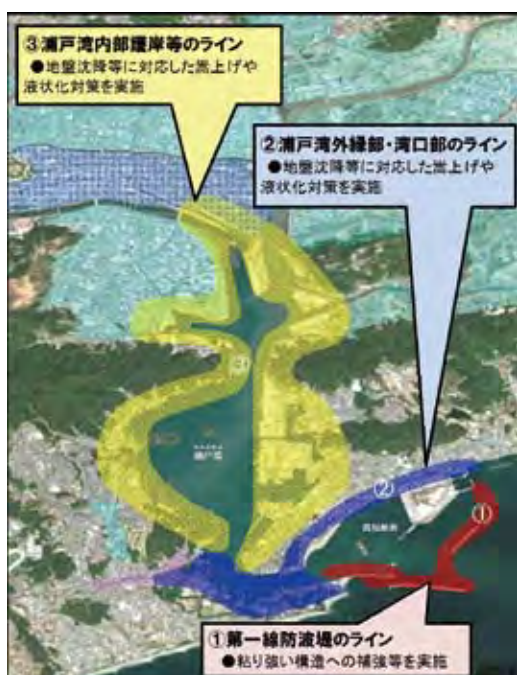
三重防護の考え方 (第2回高知港における地震津波防護の対策検討会議資料を一部修正)
