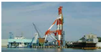
図-7 静的締固め砂杭工法※1
