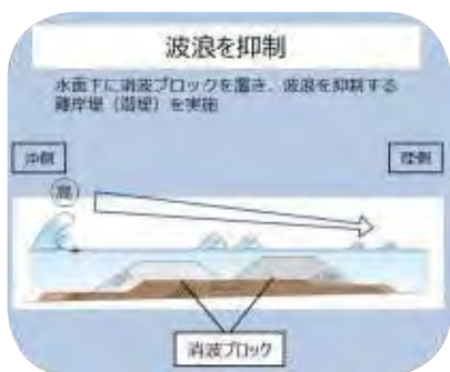
図-3 離岸堤(潜堤)
