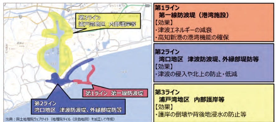
図-3 三重防護による津波浸水対策の概念図
