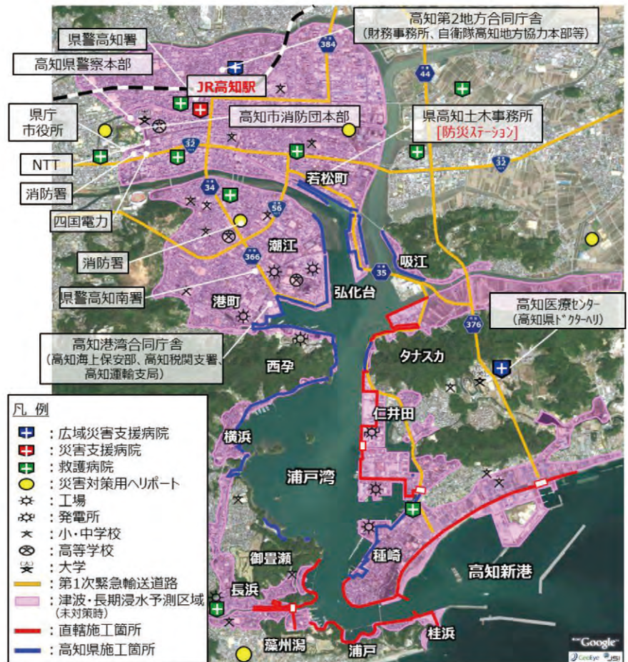
出典：東南海・南海(2003年中央防災会議、M8.6)を対象とした四国地方整備局による浸水予測図(2011年)
