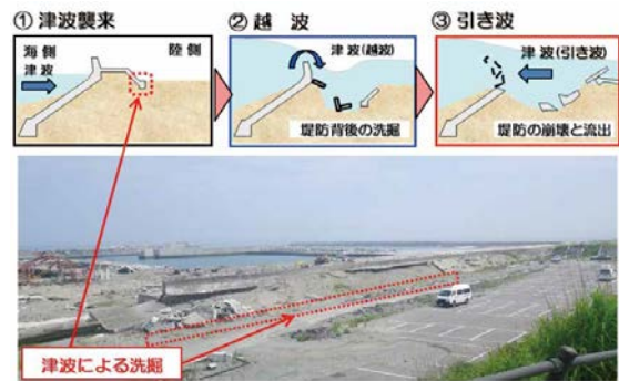
図1：堤防崩壊のプロセス
