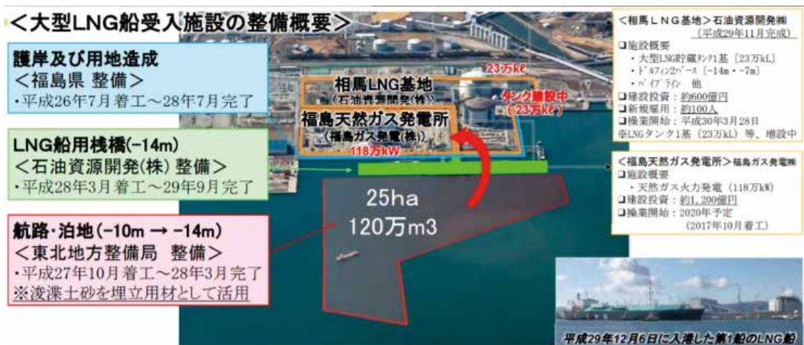
大型LNG船受入施設の整備概要
