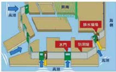
図3 東京港の海岸保全施設の仕組みを防ぎ、背後地を守っています(図3)。
