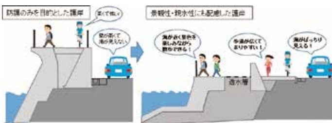
図-2 海の眺望を配慮した護岸構造
