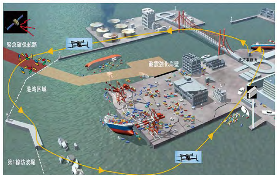
図表6 自律制御型ドローンによる被災状況把握のイメージ
