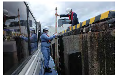
甲板と岸壁との高低差の計測(伊東港)
