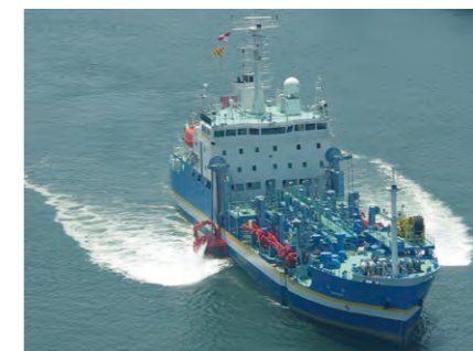
図2 大型浚渫兼油回収船「白山」油回収機(ジェット)
