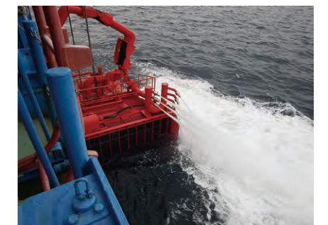
図3 大型浚渫兼油回収船「白山」油回収機(ジェット)拡大
