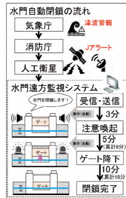
図-3:水門自動閉鎖の流れ
