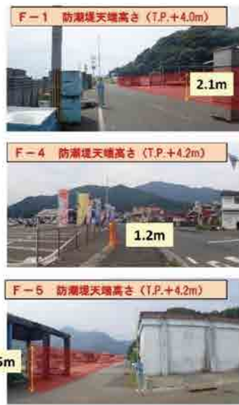
図-4 津波対策施設計画(防潮堤整備高さのイメージ・多重防護)
