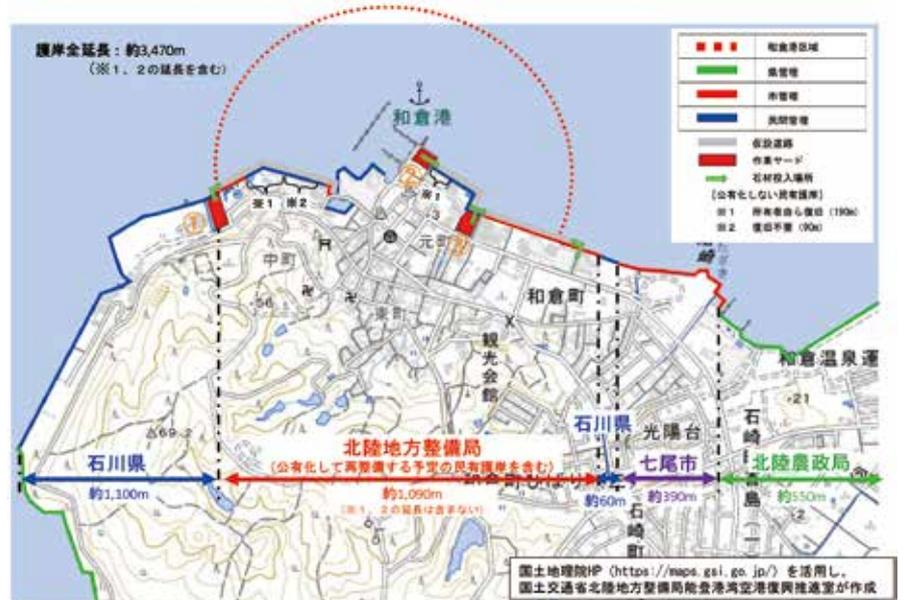
図2 位置図と護岸復旧の整備主体
