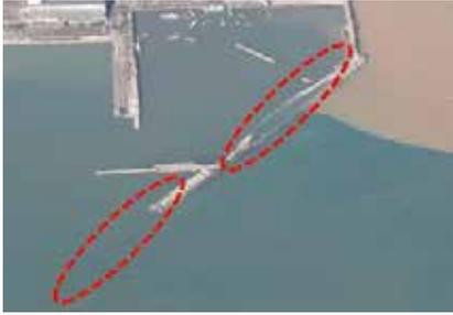
図-8 飯田港 防波堤の被災状況
