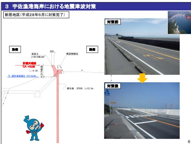
めに、新居地区というところを紹介します。こちらは国土交通省の直轄事業であります高知海岸と隣接している地区で、平成28年度に対策を完了しております。既存の防潮堤のパラペット部を撤去し、13.5メートルの鋼矢板を打ち込んだその上部にコンクリート構造物、新たなパラペットを造っているような状況です。写真の上部が対策前、下部が対策後になっています。少しコンクリートの色が黒いものから白いものへ変わって、対策が終わっているという状況が分かるのではないかと思います。
